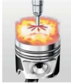
**Die Voreinspritzung** führt zu einer „weichen“ Verbrennung und damit zu einer ausgezeichneten Verbrennungsakustik und einem angenehmen Motorlauf.
