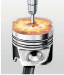
**Die Piezo-Injektoren** öffnen und schließen sich innerhalb von Bruchteilen von Millisekunden und spritzen mehrmals mit bis zu 1.800 bar in den Brennraum ein. Bei einem Einspritzvorgang werden teilweise winzigste Mengen von weniger als einem tausendstel Gramm eingespritzt.
