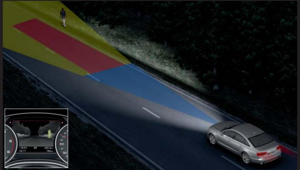
Ermittelt das System eine drohende Kollision, wechselt die Markierung von Gelb auf Rot und es erfolgt ein Warnton. Zusätzlich wird die Person durch den rechten Scheinwerfer 3x kurz nacheinander angeleuchtet (Markierungslicht).
