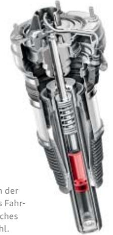
**Volltragende Luftfedern** an der Vorder- und Hinterachse des Fahrzeugs sorgen für ein sportliches und komfortables Fahrgefühl.
