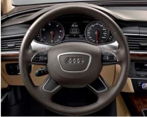
**Multifunktions-Lederlenkrad im 4-Speichen-Design** mit Fullsize-Airbag; Multifunktionsbedienkonzept zur Bedienung von Radioanlage und – falls vorhanden – Fahrerinformationssystem, Telefon, Audioquellen und Navigation; Bedienelemente in Schwarz mit Rahmen in Aluminiumoptik
