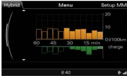
2 Balkendiagramme visualisieren in 5-minütigen Abständen den Durchschnittsverbrauch des Verbrennungsmotors (orange) und die Rekuperationsmenge des Elektromotors (grün).
