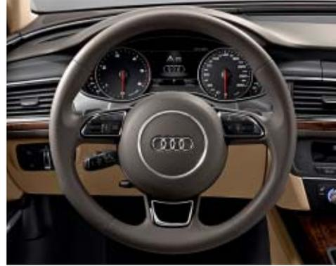
**Multifunktions-Sportlederlenkrad im 3-Speichen-Design mit Schaltwippen** für Fahrzeuge mit Automatikgetriebe: Funktionen wie Multifunktions-Sportlederlenkrad im 3-Speichen-Design, zusätzlich Schaltwippen zum manuellen Wechseln der Fahrstufen; in Höhe und Abstand einstellbar; bei S6/S6 Avant mit farblich abgesetzten Nähten und S6-Emblem sowie Schaltwippen hinter dem Lenkrad in Aluminiumoptik
